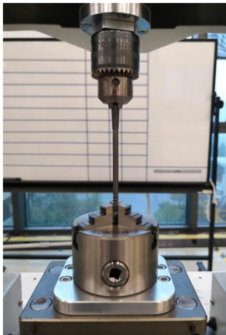
图 1 扭转测试装置图
