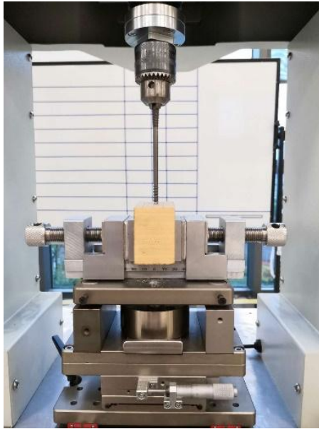
图 3 旋动性能测试装置
