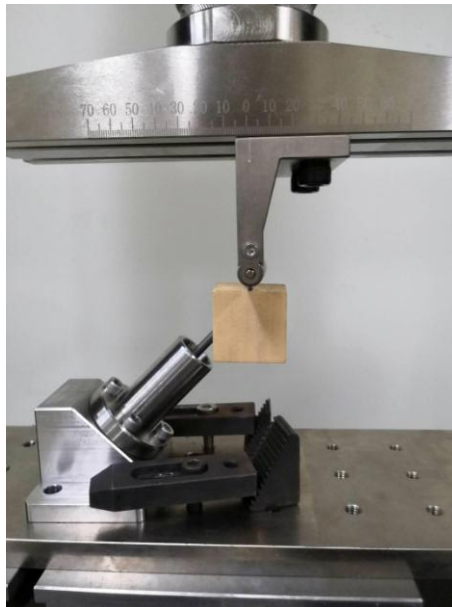
图 4 静态压弯测试装置图
