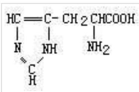
分子式： C<sub>6</sub>H<sub>9</sub>N<sub>3</sub>O<sub>2</sub>
